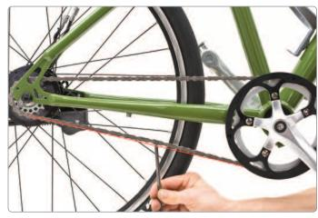
5 Maximale Kettenspannung. Die Kette lässt sich noch um fünf Millimeter nach oben drücken und zwar an der strammsten Stelle.
