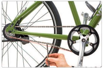
1 Kettenspannung prüfen. Sobald sich die Kette sichtbar nach oben drücken lässt – mehr wie einen Zentimeter – muss die Kettenspannung erhöht werden.
