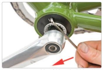
Um die Kettenspannung zu erhöhen, einfach den 4er-Inbus mit der kurzen Seite in das Loch neben dem »L« stecken – die lange Seite stützt sich rechts auf der Innenlagerachse ab – und mit Gefühl den Exzenter verdrehen.
