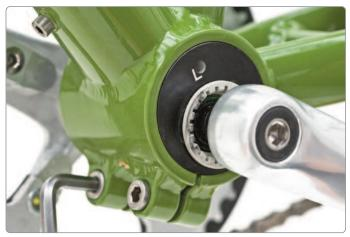
2 Lösen Sie die Spannschrauben soweit, dass der Schraubenkopf zwei Millimeter übersteht. So ist gewährleistet, dass der Exzenter sich leicht bewegen lässt.
