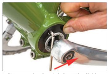
4 Kettenspannung verringern. Klemmschrauben lösen, 4er-Inbus auf der linken Innenlagerseite abstützen und Inbus leicht nach hinten drücken.
